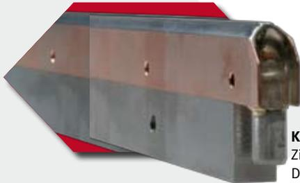
**Kühlsteg** - Verhinderung von Abrasivverschleiß bei der Zigarettenherstellung durch eine glatte gleichmäßige Dickschicht. Normale Hartchromschicht ist hier durch die „Apfelsinhaut“ weniger geeignet.
